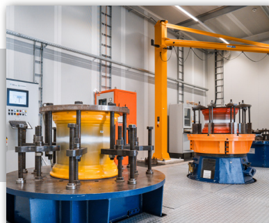
Cornering Fatigue Test Rigs
