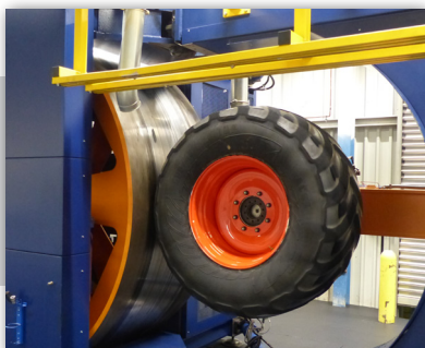
Abrollprüfstand für Radial-Ermüdungsprüfung großer OHW-Räder
