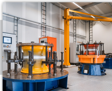
Umlauf-Biegeprüfstand für Kurvenermüdungstests
